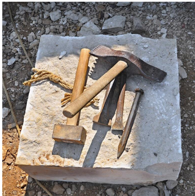
Quelques outils utilisés pour l'extraction de pierres calcaires
