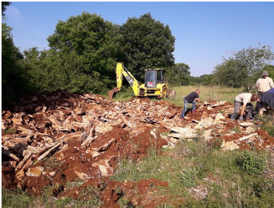
Micro-carrière de lauzes calcaires à Grèzes (46) – extraction des lauzes à maximum 80 cm de profondeur
